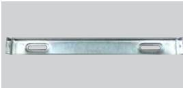
1. Установка крепежной пластины вытяжки. Для установки вытяжки на стену используйте металлическую крепежную пластину и крепежные элементы, поставляемые в комплекте. Разметьте и просверлите два отверстия для установки крепежной пластины. Установите крепежную пластину.
