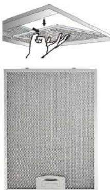
Жировой фильтр задерживает частицы масла попадающие в воздух, и в зависимости от частоты использования вытяжкой могут стать причиной закупорки фильтра. Для обеспечения противопожарной безопасности жировой фильтр рекомендуется очищать не реже одного раза в 2 месяца.
