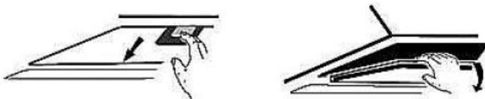
2. Закрепите угольный фильтр на штифтах, расположенных с задней стороны мотора.
