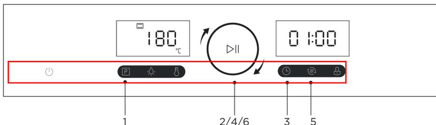
1. После того, как духовой шкаф был установлен и подключен в сеть, нажимайте на кнопку выбора режимов P, чтобы выбрать необходимый режим.
