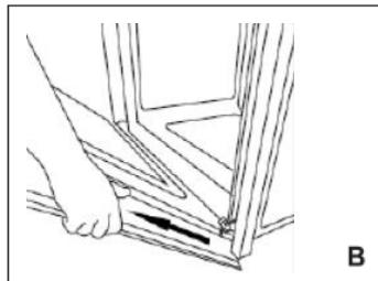
**B** Возьмите дверь обеими руками с двух сторон. Немного поднимите дверь и снимите петли с обеих позиций. Потяните дверь к себе, чтобы снять петли с отверстий рамки двери.
