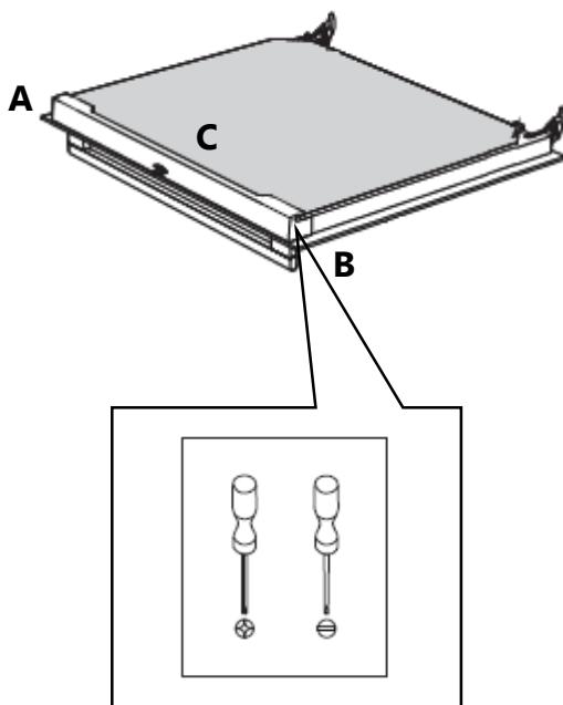
1. Для снятия внутреннего стекла снимите удерживающую планку **C**, заранее открутив винты **A** и **B**.
