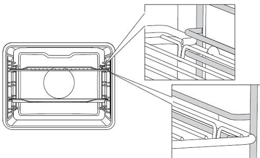
При приготовлении глубокий противень нельзя устанавливать на 1-й уровень, кроме случаев использования глубокого противня для сбора жира и мясного сока при приготовлении на гриле или вертеле.
