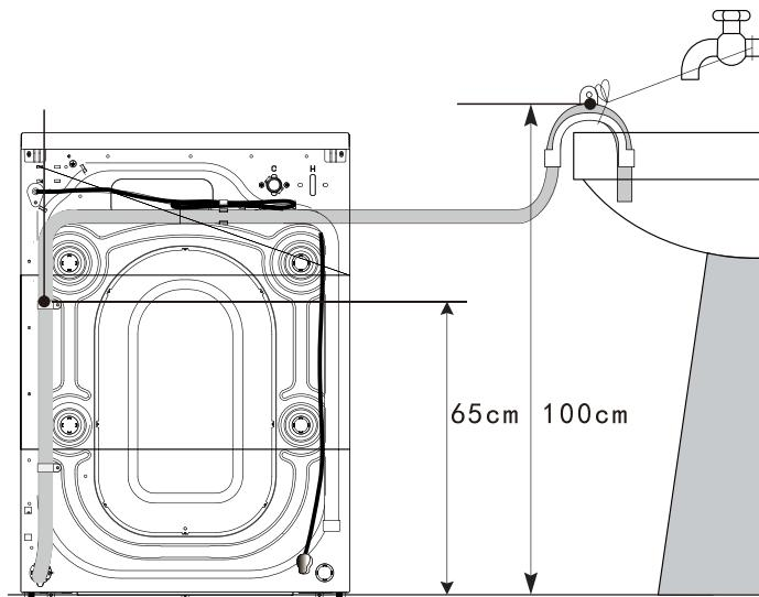
Гофрированный сливной шланг должен быть подключен к сливу на высоте 60-100 см от пола.
