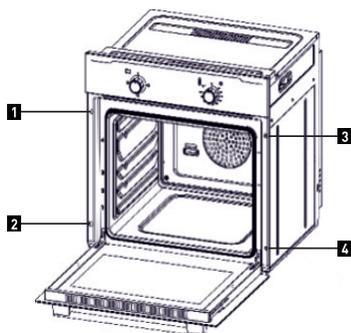
Осторожно поставьте его на основание и подвиньте до задней стенки модуля. Откройте дверцу и зафиксируйте духовку к мебельному модулю четырьмя шурупами, как показано на рисунке.
