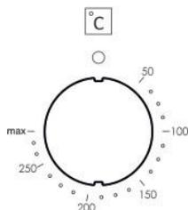
Регулирует температуру приготовления пищи во всех режимах, включая гриль. При повороте рукоятки по часовой стрелке регулируется температура внутри духовки на заданном значении между 50 и 275°C.
