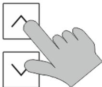
Кнопки управления духового шкафа можно заблокировать путем одновременного нажатия и удерживания кнопок
