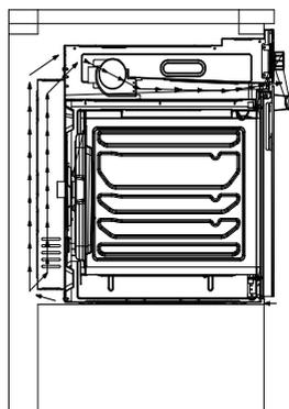
Для правильной циркуляции воздуха, духовой шкаф должен быть установлен по размерам указанным на рисунке выше. Задняя панель мебели должна быть демонтирована для беспрепятственной циркуляции воздуха. **Минимальное расстояние между духовым шкафом и стеной должно составлять 70 мм.**
