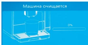
Процесс ополаскивания кофемашины автоматически прекратится.
