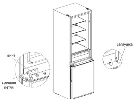
7) Поместите дверь холодильной камеры на среднюю петлю и установите верхнюю петлю, соедините клемму сигнальной цепи (2) с клеммой (1).
