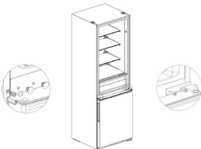
4) Снимите дверь морозильной камеры, отсоедините нижнюю петлю и извлеките заглушки.
