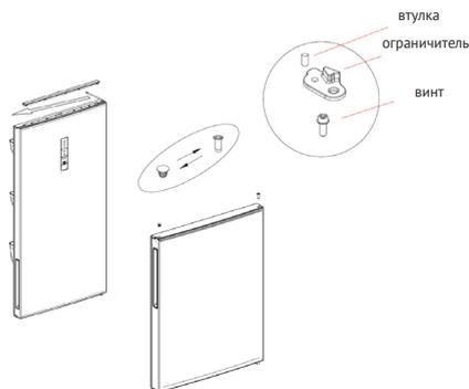
6) Поместите дверь морозильной камеры на нижнюю петлю и установите среднюю петлю, винты, колпачки, наклейку и заглушки. Снимите верхнюю крышку двери морозильной камеры, установите втулку верхней петли и подсоедините сигнальный шлейф двери с другой стороны. Снимите нижний ограничитель, втулку двери холодильной камеры и затем выполните установку с другой стороны.
