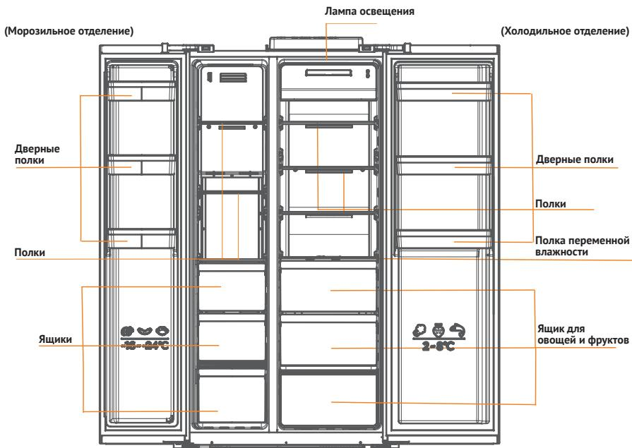
(Изображение имеет справочный характер и может отличаться от реального прибора)
