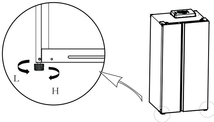
Если холодильник установлен не по уровню, дверь и магнитные уплотнители будут закрываться неплотно.
