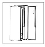
4. Снимите дверь и поместите её на мягкую подложку. Снимите вторую дверь аналогичным образом.
