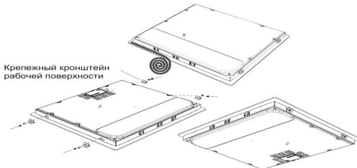
2. Вставьте варочную панель в проем кухонного модуля, выровняйте и слегка нажмите в центре вплоть до идеального прилегания варочной панели к поверхности кухонного топа.
