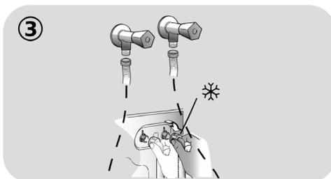
**ПОДКЛЮЧЕНИЕ К ХОЛОДНОЙ ВОДЕ / ГОРЯЧЕЙ ВОДЕ (рис. 3)**
