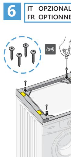
IT Fissare il kit sulla parte superiore della lavatrice utilizzando i 4 fori (facoltativo). Assicurarsi di non danneggiare la componentistica interna alla lavatrice o di entrare in contatto con parti elettriche sotto tensione.
