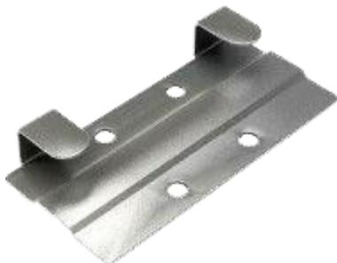
используется для крепления плит керамогранита в горизонтально-вертикальной либо вертикальной системе. Крепится к вертикальному профилю с помощью заклёпок. Используется для крепления 2-х плит керамогранита.
