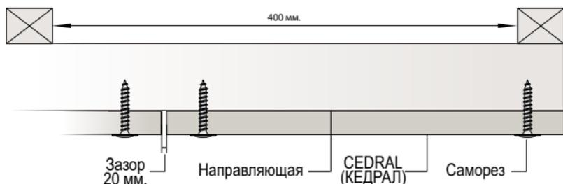
**ВАЖНО!** При подшиве кровельного свеса шаг обрешетки 400 мм. Доски могут монтироваться как параллельно фасаду так и перпендикулярно.
