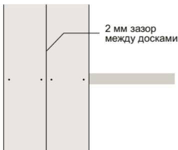
Продолжайте монтаж с зазором 2 мм.
