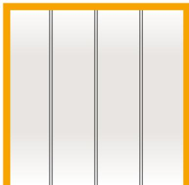
Закрепите стартовый профиль для вертикального монтажа фиброцементного сайдинга CEDRAL click (КЕДРАЛ клик). Закрепите внешний угловой профиль и/или профиль внутреннего угла и/или соединительный профиль.
