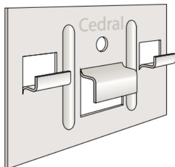
Кляймеры и саморезы изготовлены из оцинкованной стали 304 (A2)
