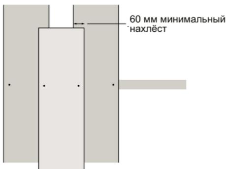
Каждая доска крепится к каждой направляющей двумя гвоздями или саморезами. Минимальный отступ от краёв доски до точки крепления 20 мм.
