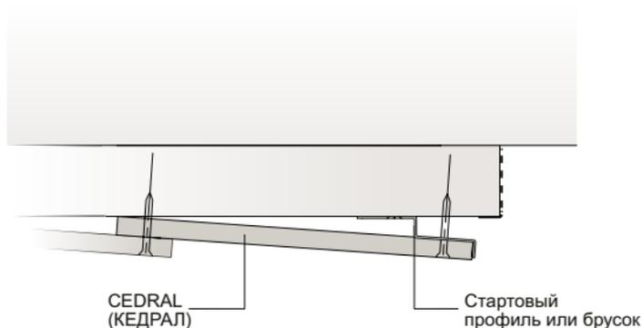
Перед установкой второй доски просверлите отверстие диаметром 2 мм для сквозного, видимого крепления. Отступ от края доски до отверстия под видимую систему крепления 15 мм.
