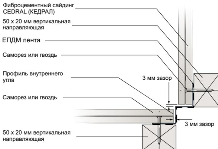
Конечный профиль для фиброцементного сайдинга CEDRAL (КЕДРАЛ). Используется в случае сочетания разных отделочных материалов на фасаде (КЕДРАЛ - кирпич, КЕДРАЛ - штукатурка, КЕДРАЛ - дерево и т.д). Так же используется при устройстве углов.
