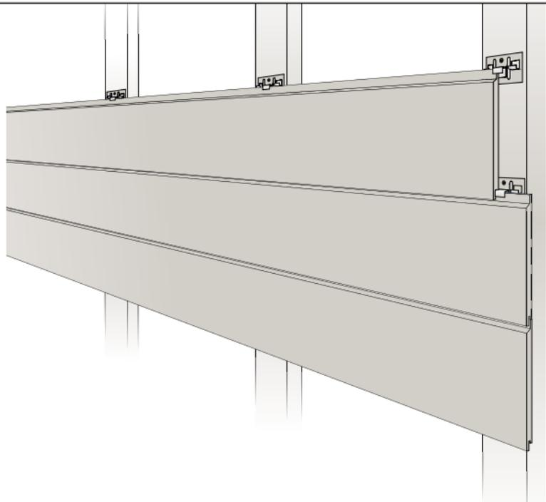
Нижний край первой доски устанавливается в стартовый профиль и проверяется строительным уровнем, если первая доска установлена в уровне - верхний край прижимается к подсистеме клиймером. Далее монтаж осуществляется при помощи клиймеров.
