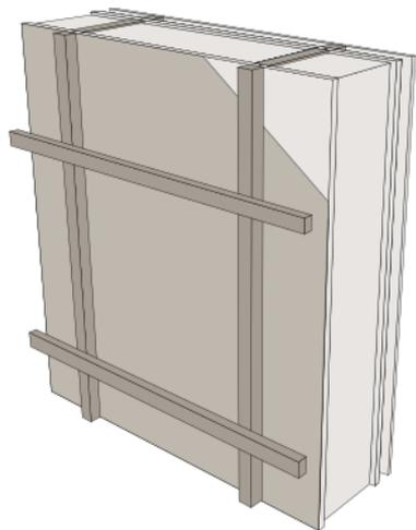
Затем устанавливаются горизонтальные направляющие. Максимальный шаг направляющих 600 мм. Минимальный размер направляющих 38 x 50 мм.
