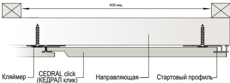
При подшиве кровельного свеса фиброцементным сайдингом CEDRAL (КЕДРАЛ) доски монтируются стык в стык с зазором 2 мм. Система крепления будет видима.
