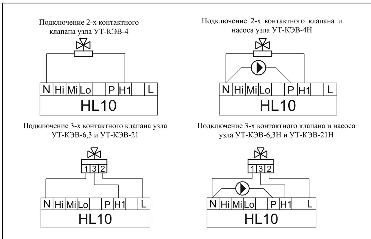
7.6.3 Насос с напряжением питания 220В/50Гц и током нагрузки не более 2А может быть подключен без БЛОКА-WA к пульту управления HL10 при условии отсутствия термостата защиты от замораживания по схеме на рисунке 12.
