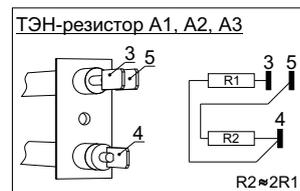
Рисунок 15. Электрическая схема блока подключения дополнительного оборудования к завесам и тепловентиляторам с водяным источником тепла и без источника тепла «БЛОК-ВА».
