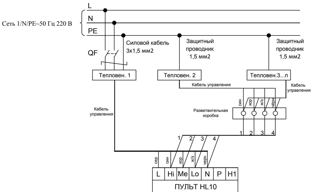
Рисунок 6.1. Схема подключения более двух тепловентиляторов к одному пульту управления HL10 с помощью БЛОК-WA.
