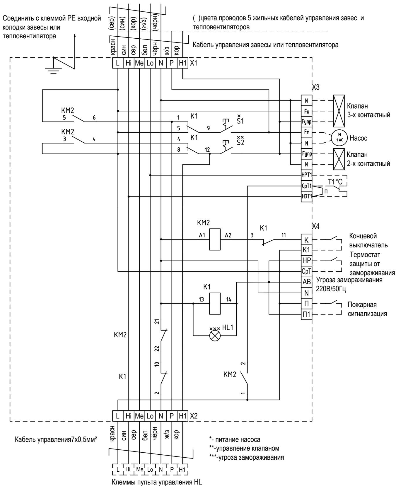
Рисунок 16. Электрическая схема пульты коммутации и управления для завес и тепловентиляторов с водяным источником тепла «ПКУ-W1 (ver 1.0)»
