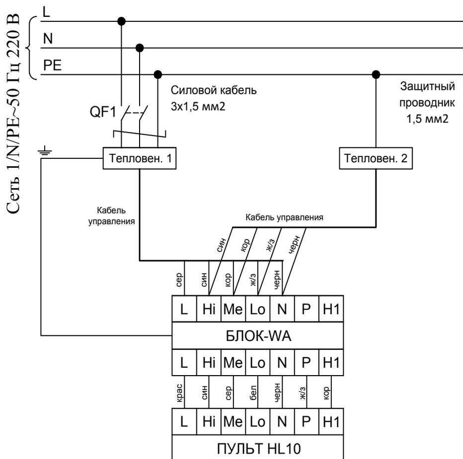
Рисунок 6. Схема подключения более двух тепловентиляторов к одному пульту управления HL10 без БЛОК-WA.
