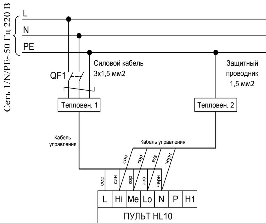
Рисунок 5.1. Схема подключения двух тепловентиляторов к одному пульту управления HL10 с помощью БЛОК-ВА.
