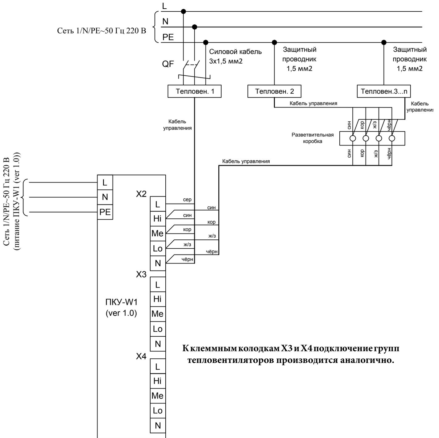
Рисунок 8. Схема подключения более двух тепловентиляторов КЭВ-180Т5,6W3 к одному пульту управления HL10 без БЛОК-WA.
