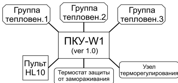
4.7.2 В случае подключения дополнительного оборудования при использовании в системе ПКУ-W1 (ver 1.0) необходимость в БЛОК-WA отпадает, так как в ПКУ-W1 (ver 1.0) предусмотрены контакты для подключения дополнительного оборудования. Подключение, логика работы тепловентилятора с дополнительным оборудованием описаны в паспорте на ПКУ-W1 (ver 1.0). На рисунке 4 показана структурная схема подключения групп тепловентиляторов через ПКУ-W1 (ver 1.0).
