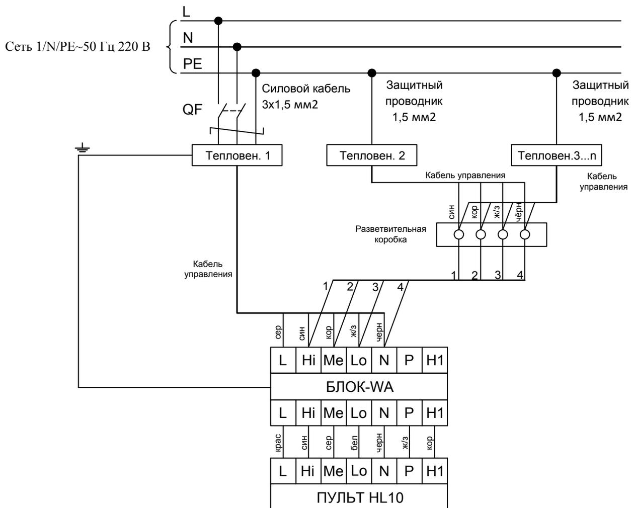
Рисунок 7. Схема подключения одной группы тепловентиляторов через ПКУ-W1 (ver 1.0)
