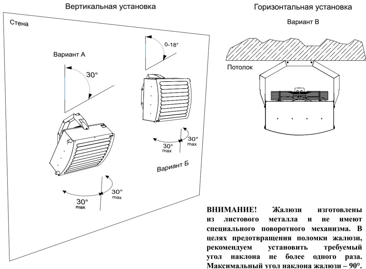
**ВНИМАНИЕ!** Жалюзи изготовлены из листового металла и не имеют специального поворотного механизма. В целях предотвращения поломки жалюзи, рекомендуем установить требуемый угол наклона не более одного раза. Максимальный угол наклона жалюзи – 90°.
