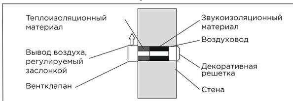
Рис. 2 Тип установки №2
