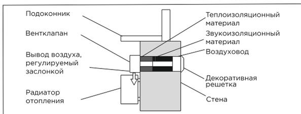
Рис. 1 Тип установки №1
