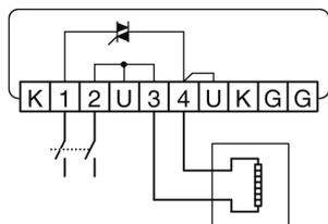
Встроенные датчик и термодатчик
