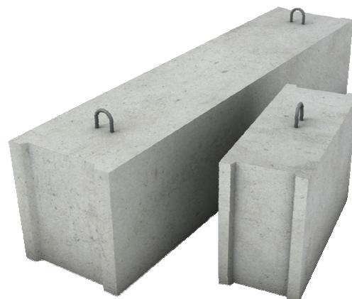
Фундаментные стеновые блоки представляют собой изделия из тяжелых, плотных силикатных и керамзитовых видов бетона, предназначенные для возведения сборных оснований, стен подвалов, цоколя и обустройства подполья.
