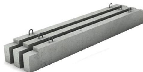
Железобетонные прогоны — изделия из армированного бетона, обладающие высоким уровнем сопротивления изгибающим нагрузкам. Они выполняют функцию балок-перекрышек, опираются на стены здания и специальные опоры — фермы или ригели.
