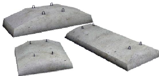
Железобетонные плиты для ленточных фундаментов можно использовать в качестве колонн при возведении кирпичных зданий малой этажности. Плоская и широкая часть плит выступает в качестве надежной опоры для конструкции, монтируясь прямо на грунт. Узкая часть блока, похожая на трапецию в разрезе, предназначена для того, чтобы послужить основанием стены.
