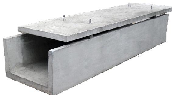
**Железобетонные каналы и тоннели** из лотковых элементов предназначены для прокладки внутри, и вне зданий в промышленном, гражданском и жилищном строительстве. В каналах и тоннелях могут прокладываться трубопроводы различного назначения, электрокабели и электрошины. Возможно применение каналов для непосредственной транспортировки по ним жидкостей.
