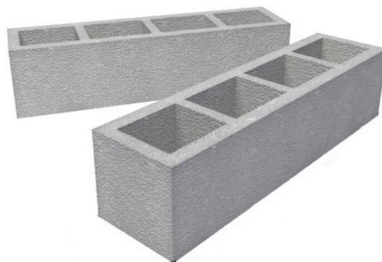
Используются при возведении стен подвалов, строительстве ленточных фундаментов и подпорных стен, а также для создания сборно-разборных фундаментов под машины, расположенные в промышленных производственных зданиях.
