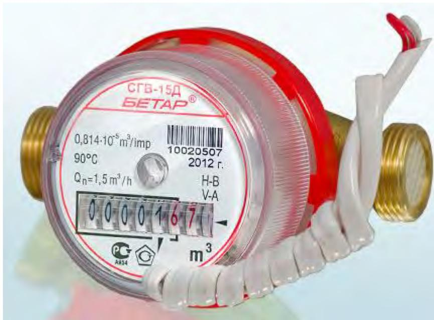
Счетчики предназначены для измерения объема холодной и горячей питьевой воды по СанПиН 2.1.4.1074-2001, протекающей по трубопроводу при температуре от плюс 5 до плюс 90°C и давлении не более 1,0 МПа (10 кгс/см<sup>2</sup>).
