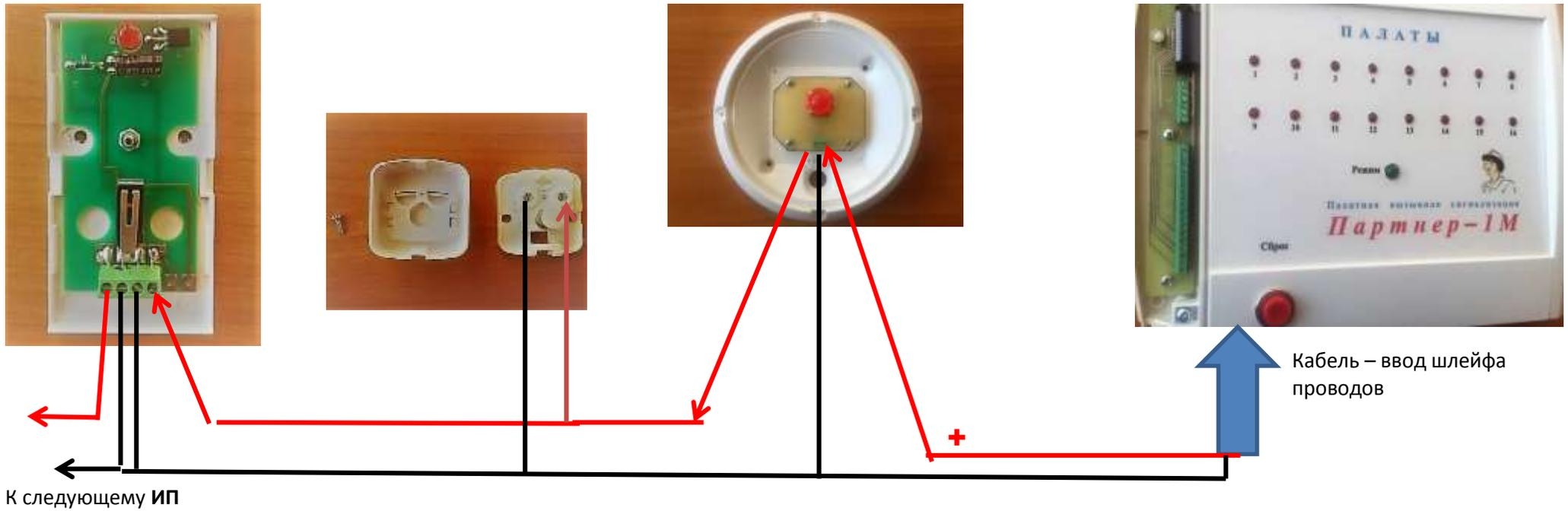
СХЕМА ПОДКЛЮЧЕНИЯ ЭЛЕМЕНТОВ ПВС «ПАРТНЕР – 1М»
