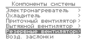
«Резервные вентиляторы» Позволяет добавить дополнительный приточный и вытяжной вентилятор.
