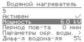
«Мощность» задаёт пропорцию управляющего сигнала ПИ-регулятора выделяемого на водяной нагреватель во время работы системы вентиляционной установки. Для настройки мощности водяного нагревателя необходимо выбрать пункт «Мощность» и нажать энкодер. В пункте «Мощность» ввести
