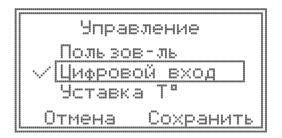
Переключение режима проводится по сигналу на сконфигурированном цифровом входе.
