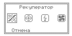
Важно! Редактирование производится только на выключенной установке.
