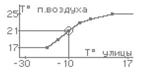
Для настройки одной из шести температурных точек, поворотом энкодера выберите точку и нажмите энкодер. Режим выбора температурных точек обозначен индикатором окружности вокруг точки.
