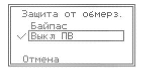
В открывшемся окне, необходимо выбрать требуемый способ разморозки (Байпас или выключение приточного вентилятора) и нажать энкодер. Для подтверждения выбора устройства рекуперации — необходимо выбрать вкладку с символом  $\checkmark$  и нажать энкодер.
