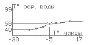
Выбранная для регулирования точка, обозначена индикатором горизонтальных стрелок регулирования для ПО горизонтальной оси температуры улицы (T° Выберите поворотом улицы). энкодера необходимую температуру улицы и нажмите энкодер.
