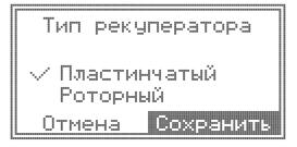
Для подтверждения выбора устройства рекуперации – необходимо выбрать вкладку «Сохранить» и нажать энкодер. Для отмены выбора - необходимо выбрать вкладку «Отмена» и нажать энкодер.
