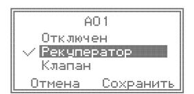
В меню **«Аналоговые выходы»** выбрать пункт АО1 (например) и нажать энкодер (по умолчанию **«Отключен»**). Далее поворотом энкодера выбрать требуемое устройство из списка возможных аналоговых выходов и нажать энкодер:
