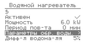
Параметры обр. воды Для выбора параметров обратной обратной воды выберите пункт **«Параметры обр. воды»** и нажмите энкодер.
