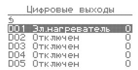
В меню «Цифровые выходы» выбрать пункт DO1(например) и нажать энкодер (по умолчанию «Отключен»). Далее нажать энкодер и поворотом энкодера выбрать требуемое устройство из списка возможных цифровых выходов из таблицы ниже и нажать энкодер: После сделанного выбора, нажать кнопку сохранить.
