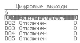
Справа от названия цифрового выхода, цифрами 0 показано 1 или текущее состояние. Например: «DO1 Эл.нагреватель». Для отключения выбранного цифрового выхода в окне списка возможных цифровых выходов необходимо выбрать пункт «Отключен» нажать энкодер. Незадействованный цифровой выход размыкает реле контроллера.
