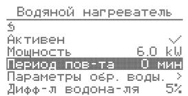
Если греть не нужно, в режиме остановки то один раз будет производится включение насоса на 1(одну) минуту. Время через которое будет происходить включение, задается в этом пункте меню «Период пов-та»
