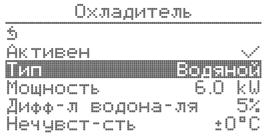
Если выбран водяной тип охладителя, необходимо настроить мощность, нечувствительность, минимальное и максимальное значение клапана в [%], а также дифференциал водонагреваетля.
