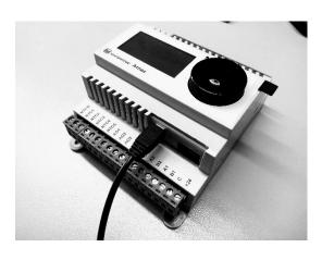
Для установки (замены) программного обеспечения контроллера необходимо остановить работу контроллера.
