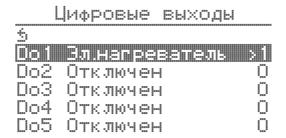
После нажатия энкодера, изменится индикатор состояния цифрового выхода, справа от пункта «D00 Рекуператор» («D00 Эл.нагреватель 1»), и щёлкнет реле внутри контроллера. При выходе ИЗ меню «Цифровые В выходы» меню «Конфигурация» все выставленные значения цифровых выходов возвращаются к исходным значениям.
