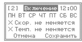
Далее настраиваем «Включение». Здесь также выбираем нужный день недели, время, и дополнительно можем задать скорость вентилятора при включении и температуру уставки. После внесения изменений, обязательно нажать кнопку сохранить.
