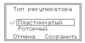
В строке, в списке устройств рекуперации (пластинчатый, роторный, заслонки) поворотом энкодера выбрать требуемое устройство и нажать энкодер.
