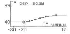
Для настройки одной из шести температурных точек, поворотом энкодера выберите точку и нажмите энкодер. Режим выбора температурных точек обозначен индикатором окружности вокруг точки.
