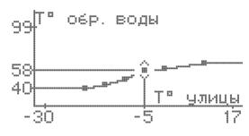
После выбора температуры улицы выбранная ДЛЯ регулирования точка обозначена индикатором вертикальных стрелок для регулирования по вертикальной оси температуры обратной воды (T° обр. воды). Выберите поворотом энкодера необходимую температуру обратной воды и нажмите энкодер.
