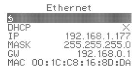
Для самостоятельной настройки IP адреса контроллера, в меню **«Ethernet»** снимите галочку с DHCP, затем выберите пункт IP и нажмите энкодер для перехода к редактированию IP адреса.
