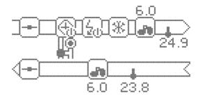
При выходе из главного меню будет отображена мнемосхема с выбранными компонентами, их состоянием и данными с температурных датчиков.
