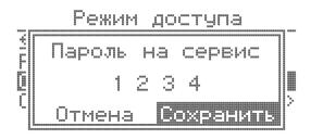
Для сохранения нового пароля необходимо выбрать вкладку с «сохранить» и нажать энкодер. Для отмены выбора - необходимо выбрать вкладку «Отмена» и нажать энкодер.
