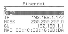
По умолчанию в контроллере «Атлас» включен ручной режим настроек интерфейса Ethernet. Для автоматической настройки параметров Ethernet в меню «Ethernet» выберите пункт «DHCP» и нажмите энкодер.
