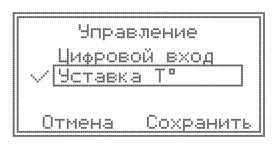
По установленной температуре. В этом пункте меню задается нужное значение температуры, при которой произойдет переключение. Устанавливается гистерезис производится активация данного режима управления.
