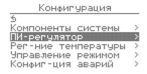
Для настройки параметров ПИ-регулятора приточного воздуха необходимо выбрать в меню **«Конфигурация»** пункт **«ПИ-регулятор»** и нажать энкодер.
