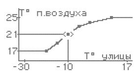
Выбранная для регулирования точка, обозначена индикатором горизонтальных стрелок для регулирования по горизонтальной оси температуры улицы (Т° улицы). Выберите поворотом энкодера необходимую температуру улицы и нажмите энкодер.
