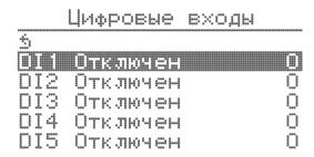
В меню «Цифровые входы» выбрать пункт DI1 (например) и нажать энкодер (по умолчанию «Отключен»). Далее поворотом энкодера выбрать требуемое устройство из списка возможных цифровых входов:
