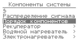
«Порядок компонентов» Позволяет определять порядок компонентов системы.
