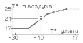
После выбора температуры улицы выбранная ДЛЯ регулирования точка обозначена индикатором вертикальных стрелок для регулирования по вертикальной оси температуры обратной воды (T° п. воздуха). Выберите поворотом энкодера необходимую температуру приточного воздуха и нажмите энкодер.
