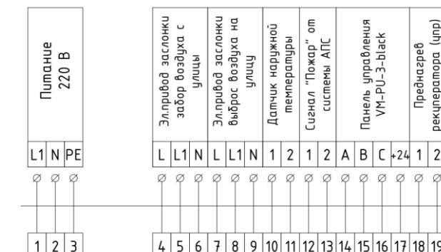
При использовании многожильных проводов рекомендуется перед их затяжкой впрессовывать концы проводов в наконечники. Усилие затяжки не более 2,5 Нм. Заземлить корпус установки.
