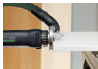
Скругление пластмассовой или деревянной кромки.
