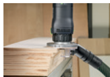
Фрезерование пластмассовой или деревянной кромки.
