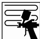
Нанесите первый полный слой на зону перехода, следующий слой нанесите с плавным выходом в сторону заполированной поверхности.
