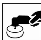
Полировку зоны перехода можно выполнить вручную или с использованием полировальной машинки с применением полировальных паст. Если есть необходимость можно использовать более грубую полировальную пасту. *Полируя машинкой необходимо использовать мягкий полировочный круг, при необходимости можно использовать жесткий полировочный круг.*
