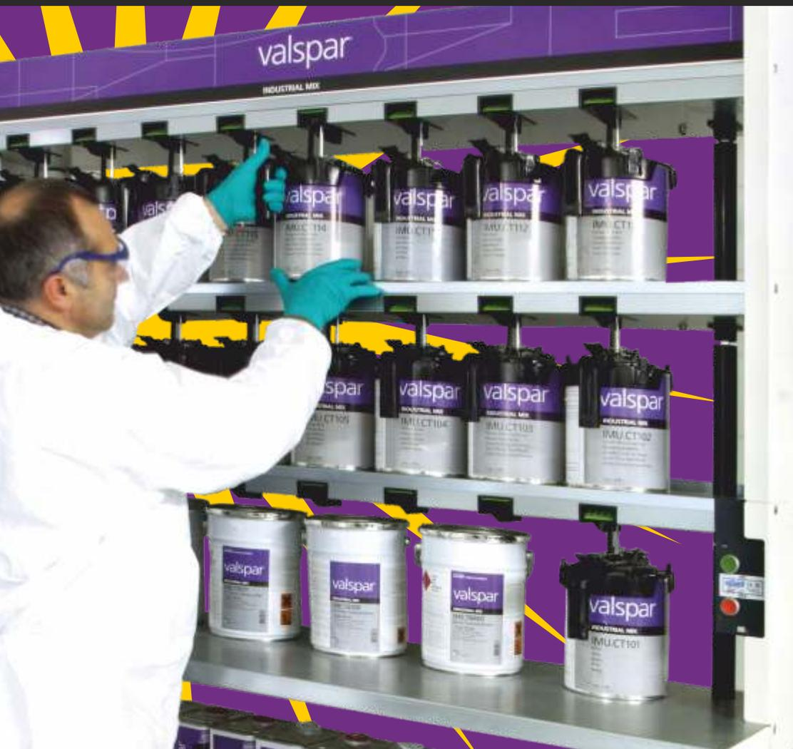
Для сокращения времени на поиски нужного цветового оттенка и достижения максимального цветового соответствия концерн Valspar разработал систему подбора промышленных эмалей, с помощью которой путем смешивания базовых цветов в определенных пропорциях можно получать необходимые цветовые оттенки.
