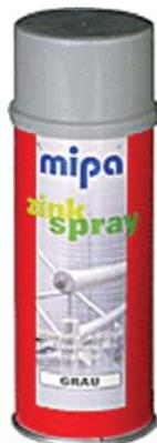
**Mipa Zinc-Spray** — Высококачественный богатый цинком материал с длительной защитой против коррозии для изделий из железа. Рекомендуется для автомобильных кузовных работ, исправления повреждённых оцинкованных поверхностей, защиты мест сварки и сверления. Особенно удовлетворяет для точечной сварки. Содержит больше чем 90% металлическую цинковую пыль в сухом остатке. Высокая защита против коррозии. Обладает высокой температурной стойкостью до 300°C.
