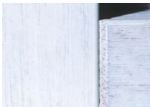
Проникновение влаги через необработанное V-образное соединение
