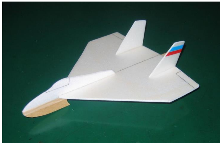
Носик фюзеляжа - пенопласт 4 мм
