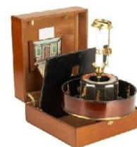
Праксиноскоп- оптический прибор, позволяющий видеть последовательность из нескольких рисунков как плавное движение (1877 г.)
