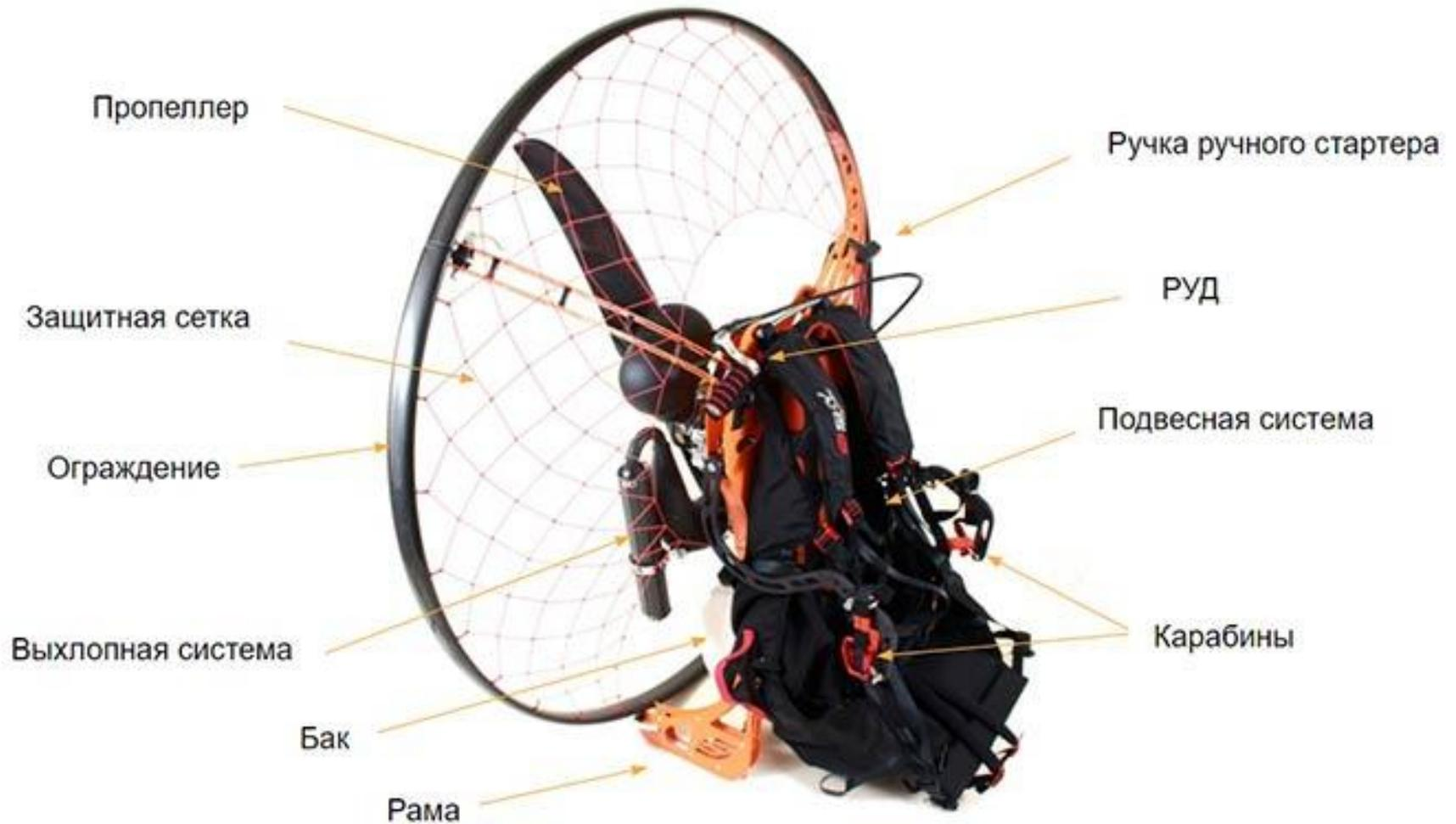
**Паралет – тележка с двигателем и с парашланерным крылом.**
