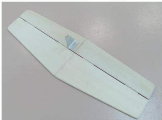
Киль и стабилизатор стыкуются друг с другом «в шип». Петли навесы руля высоты – капроновые или лавсановые. Хвостовое оперение собирается в единый узел и в таком виде приклеивается на хвостовую часть фюзеляжа. На реле высоты крепится кабанчик, сделанный из мягкого дюрала толщиной 1,5 мм. Крепится на руле при помощи заклёпок диаметром 2 мм. Предварительная отделка оперения полностью аналогична фюзеляжу.
