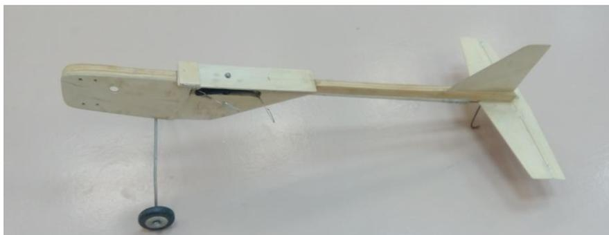
Для крепления двигателя нужно просверлить по разметке отверстия диаметром 3,3 мм. Примерьте двигатель к мотораме и убедитесь, что проблем с его установкой и креплением нет. Далее размечаются и сверлятся отверстия под ось качалки и под саморезы для крепления крыла. Из берёзовой фанеры толщиной 2 мм выпиливается пластина 150 x 40 мм. Соблюдая симметрию, её приклеивают на верхний торец фюзеляжа (так получится ложемент крыла).
