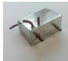
Для крепления бака к нему припаиваются ушки из жести или латунные грибки с внутренней резьбой 3 мм. Перед монтажом бак нужно тщательно промыть для удаления остатков флюса и проверить его на герметичность.
