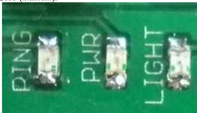
Рис. 3. Индикаторы состояния контроллера
