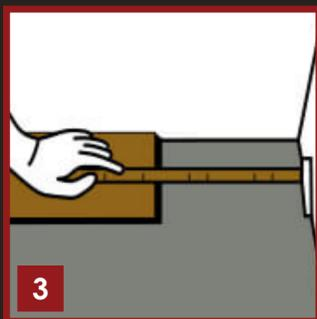
В конце первого ряда оставьте расширительный зазор 6 мм с торца и измерьте длину последней доски (рис. 3).
