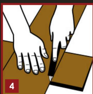
Для того чтобы отрезать доску вам потребуются строительный нож и металлическая линейка (правило). Сделайте надрез на лицевой стороне доски, затем сломайте доску по линии надреза (рис. 4).
