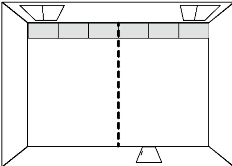
При продольной укладке, укладывайте первый ряд плиток точно вдоль базовой линии разметки. Точно совмещайте и прижимайте первую и вторую плитки друг к другу короткими сторонами. С нажимом прокатайте их сверху жестким валиком.
