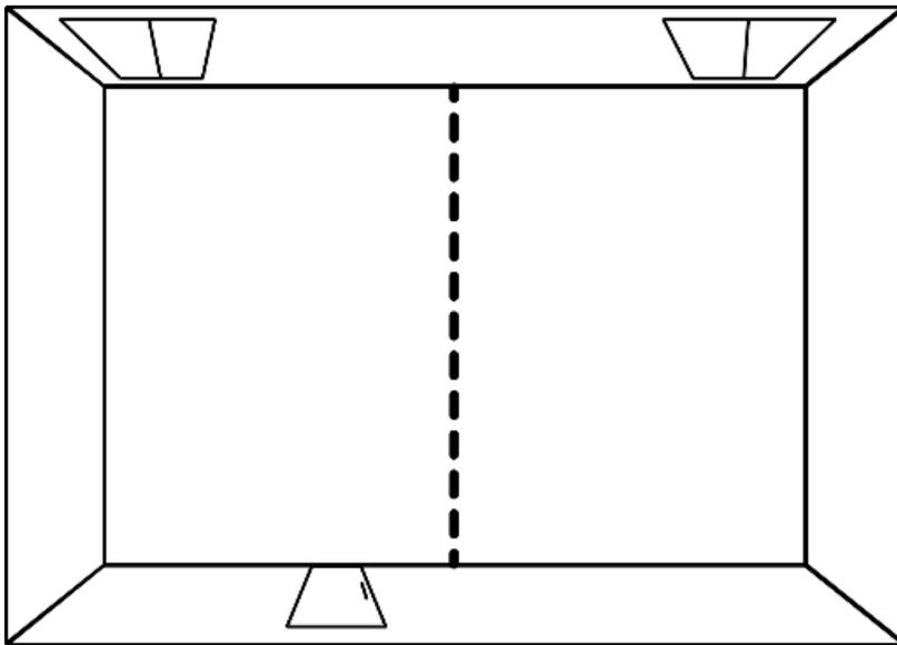
Выберите направление монтажа плитки и вариант (узор) укладки. Произведите расчет укладки всей плитки относительно размеров помещения и определите положение первой базовой линии для разметки первого ряда, так, чтобы крайние ряды возле стен не были слишком узкими.
