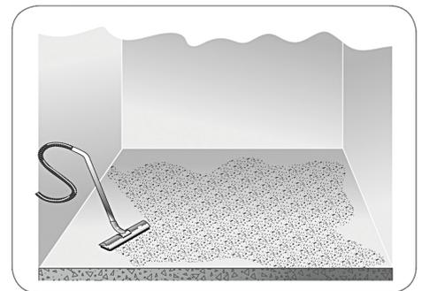
Всегда существует опасность повышенной влажности пола, на который укладывается покрытие. Поэтому необходимо обеспечить влагозащитный барьер! (3А)
