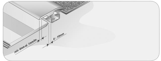
**Температурный зазор устанавливается в дверных проемах любого помещения (переход из комнаты в комнату, коридор) при сочетании разных материалов и покрытий разной толщины.**
