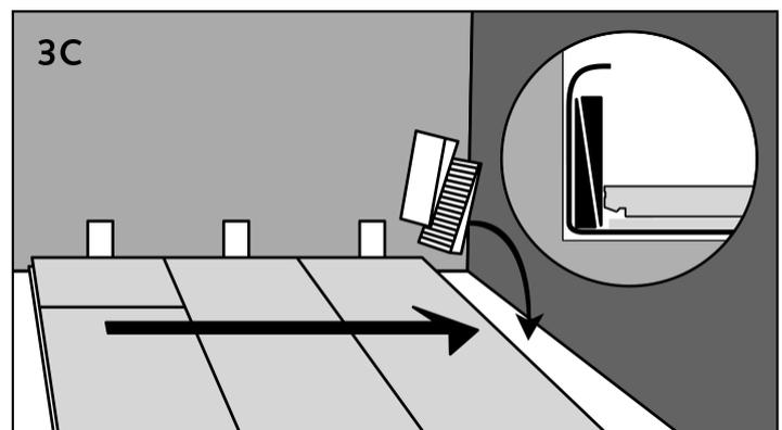
Расположите половицу под углом к горизонтали планки предыдущего ряда, вставьте паз в шпунт и подтолкните половицу немного вперед, одновременно нажимая на нее сверху. Почувствуйте «стыковку» и опустите планку горизонтально. Продолжайте укладку, соединяя планки по короткой стороне.
