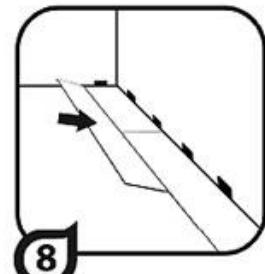
13. Для следующей пластины второго ряда: состыкуйте короткий конец пластины с предыдущей пластиной.
