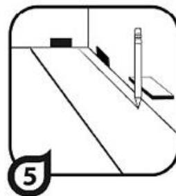
10. Начинайте с укладки первого ряда пластины с левого угла комнаты. Расположите первую пластину в угол выемкой (A) к стене. Не забудьте о зазорах на расширение с обеих сторон комнаты. Уложите первый ряд по всей длине комнаты. Смочите влажной губкой либо паз (A), либо шип (B) профиля CLICK, чтобы облегчить монтаж.
