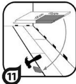
17. Последний ряд: положите все пластины последнего ряда поверх предпоследних уже установленных пластин. Возьмите еще одну пластину (линейку) и карандаш, нарисуйте форму стены, которая должна учитывать 10-миллиметровый зазор на расширение. Используйте брускок для подбивания, чтобы облегчить укладку последнего ряда.
