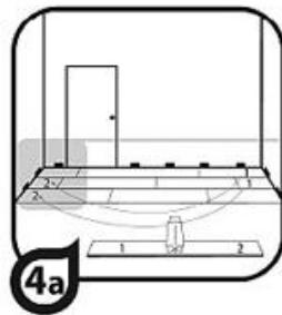
8. Ламинат AquaFloor монтируется как съемное без применения клея или других крепежных материалов напольное покрытие.
