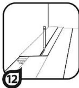
18. Для труб: просверлите отверстия того же диаметра, что и трубы, и добавьте 15 мм, сделайте прорези по диагонали от этих отверстий электролобзиком. Приложите вырезанный по размеру фрагмент пластины. Для фиксации этого фрагмента можно использовать специальный клей.
