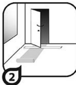
5. Удалите всю пыль, а так же удалите все неровности, превышающие 2 мм. Нижний слой, на который будет производиться укладка должен быть твердым, без подвижных частей и ровным, с перепадами уровней, не превышающими 3 мм/метр.
