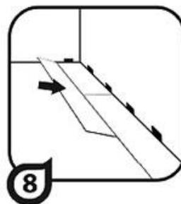
13. Для следующей пластины второго ряда: состыкуйте короткий конец пластины с предыдущей пластиной.
