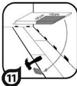
17. Последний ряд: положите все пластины последнего ряда поверх предпоследних уже установленных пластин. Возьмите еще одну пластину (линейку) и карандаш, нарисуйте форму стены, которая должна учитывать 10-миллиметровый зазор на расширение. Используйте брусок для подбивания, чтобы облегчить укладку последнего ряда.
