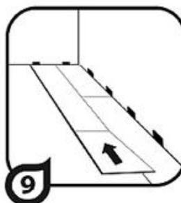
14. Приподнимите состыкованные с торца пластины. Предыдущие пластины в этом же ряду тоже поднимутся. Закрепите состыковав их торца, жестко прищелкнув его по длине к первому ряду.
