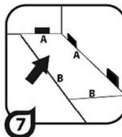
11. Закрепите первый ряд при помощи обрезков или расширительных клиньев перед началом монтажа второго ряда. Убедитесь, что вдоль стены имеется зазор в 10 мм.
