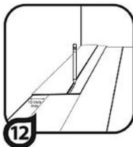
18. Для труб: просверлите отверстия того же диаметра, что и трубы, и добавьте 15 мм, сделайте прорезы по диагонали от этих отверстий электролобзиком. Приложите вырезанный по размеру фрагмент пластины. Для фиксации этого фрагмента можно использовать специальный клей.
