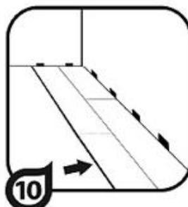
15. После того, как пластины состыкованы, положите их на подложку. При необходимости используйте киянку или обрезок пластины размером 10 см x 10 см.
