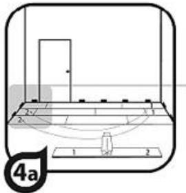
8. Ламинат AquaFloor монтируется как съемное без применения клея или других крепежных материалов напольное покрытие.
