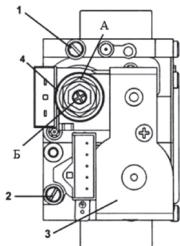
1. Штуцер газового клапана для измерения давления на горелке
