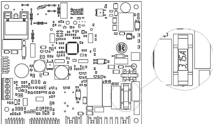
Рис. 11. Расположение предохранителя
