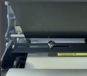
Датчики носителя - нижний и верхний отражатели, обеспечивающие совместимость со множеством типов материала для печати
