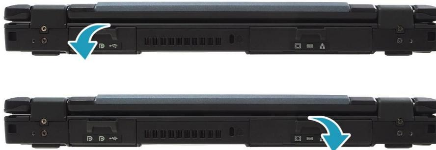
2. Подключите один конец кабеля mini DisplayPort или VGA к порту Mini DisplayPort или VGA ноутбука.
