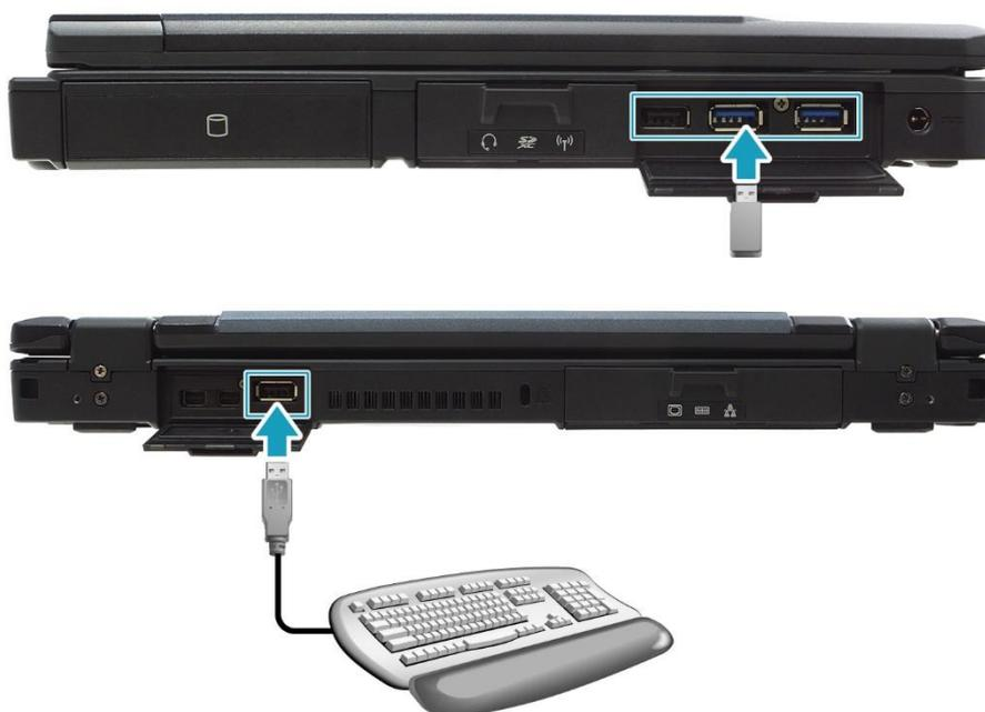
3. Второй конец USB кабеля подключите к USB-устройству.
