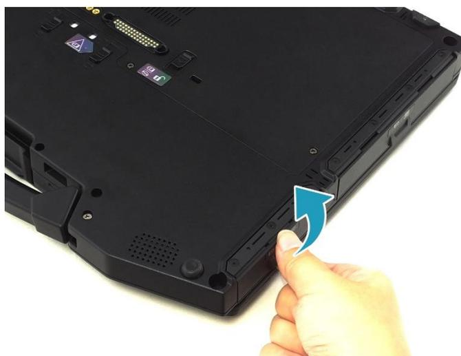
2. Сдвиньте кнопку разблокировки защелки аккумулятора вверх и удерживайте ее на месте. Тяните аккумулятор наружу.
