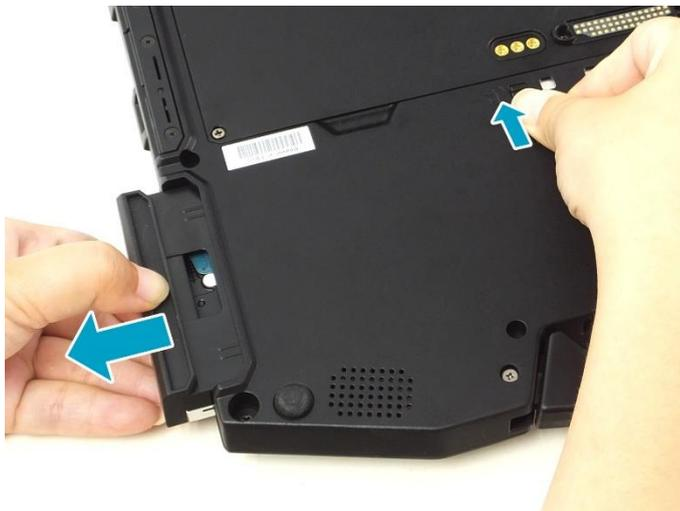
3. Вставьте в отсек новый жесткий диск. Вставьте до упора, чтобы жесткий диск сел на место.
