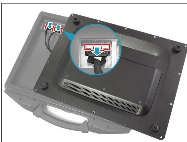
10. Установите нижнюю часть модуля расширения.
