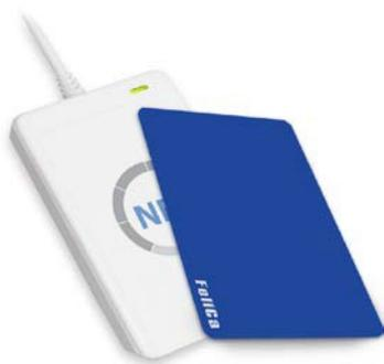
ACR122U – это подключаемое к компьютеру устройство для чтения и записи на смарт-карты, разработанное на основе бесконтактной технологии 13,56 МГц. Это первое в мире устройство для бесконтактного чтения и записи на смарт-карты, совместимое со стандартом CCID и соответствующее стандартам ISO 14443 и ISO 18092. ACR122U поддерживает не только карты Mifare и карты стандарта ISO 14443 типов A и B, но и метки FeliCa и NFC.
