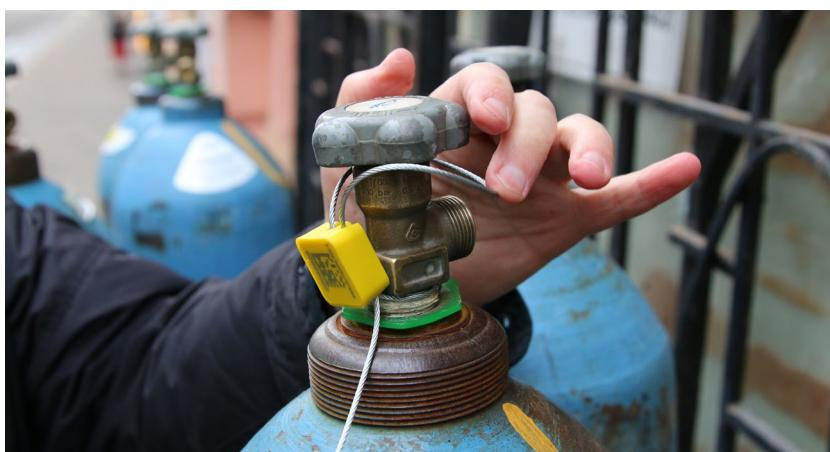
Затяните вторую петлю и отрежьте лишний трос тронзорезом для возможности беспрепятственно надеть колпак баллона.
