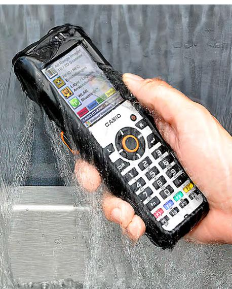
Устройство обладает оптимальной защитой от воздействия пыли и влаги в соответствии со стандартом IP67. Оно полностью сохраняет работоспособность в диапазоне температур от -20 до +50 °С. Дождь и прямые лучи солнца, а также экстремально низкая температура не влияют на характеристики терминала CASIO DT-X200. Хорошо сбалансированная конструкция
