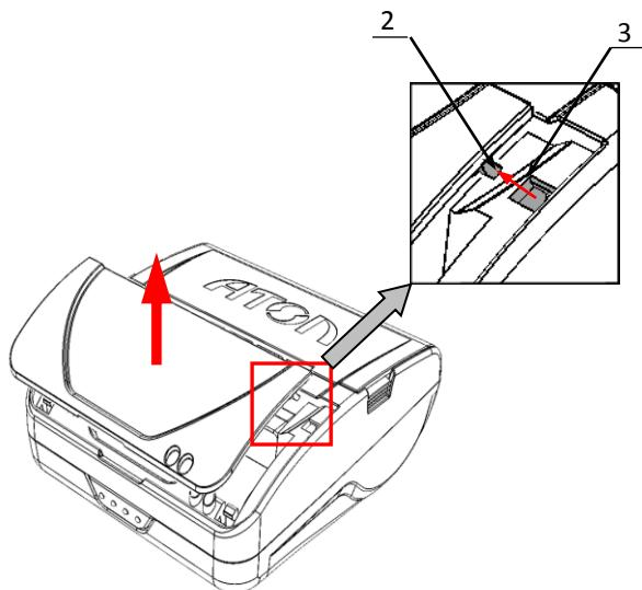
3. Освободить фиксаторы крышки **2** из пазов **3** в центральной части корпуса ККТ.
