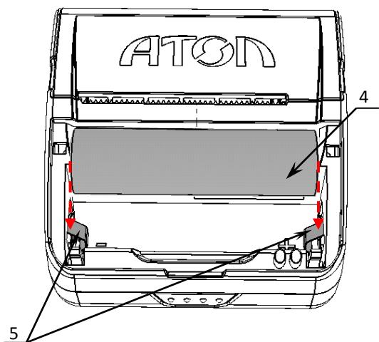
Рисунок 5. Установка аккумулятора
