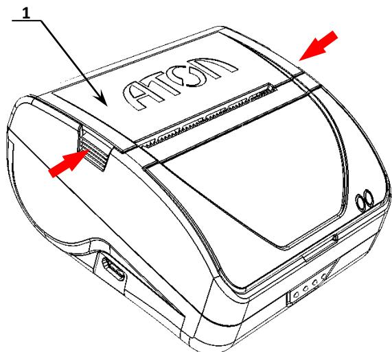
Рисунок 7. Места приложения усилий при открытии крышки
