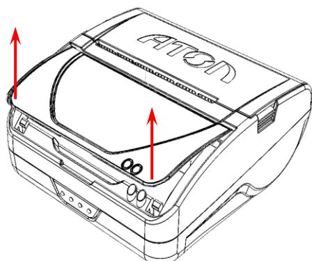
2. Приподнять переднюю часть крышки.
