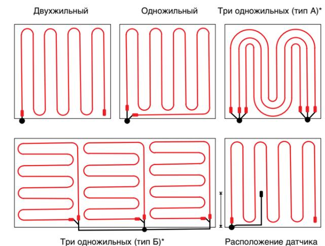
Тип А и Б — трехфазная система с подключением по схеме типа звезда/треугольник. При распределении мощности на три фазы систему подключают к терморегулятору через контактор.
