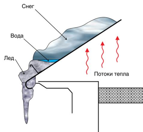
Тепло, поступающее через верхнее перекрытие и чердачное пространство, достигает кровли. Таким образом, происходит нагрев кровли, что при небольших отрицательных температурах наружного воздуха может привести к положительной температуре на поверхности самой кровли. В результате происходит таяние снега на кровле и образуется сток талой воды в водосток, который в свою очередь лишен «паразитного» подогрева. В холодном водостоке вода замерзает, образуя сосульки и наледь.
