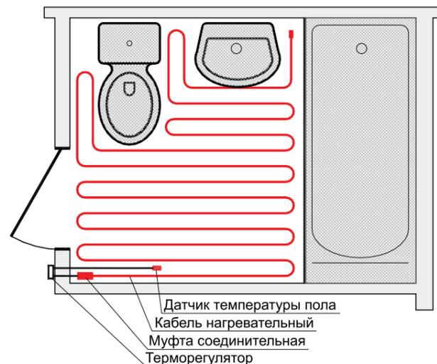
1. Определить место установки терморегулятора (при необходимости сделать штробу в стене для скрытой проводки). Выделить свободную площадь. Нарисовать схему раскладки нагревательного кабеля. При необходимости предусмотреть теплоизоляцию и промежуточный материал (например, армирующая сетка и/или предварительная стяжка).
