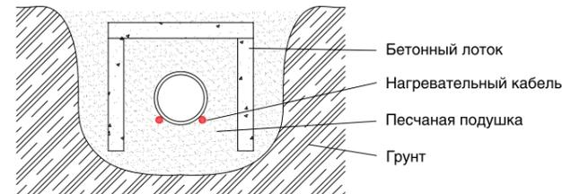
**Труба с нагревательным кабелем, установленным в грунте.**
