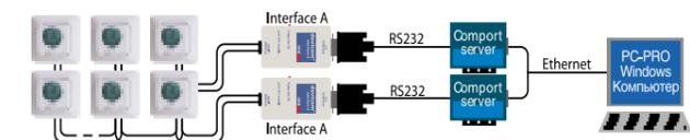
Объединение терморегуляторов в сеть осуществляют «параллельно». Провода могут быть не экранированы, не свиты в пару и не иметь полярности. Максимальная длина всех проводов сети не должна превышать 500 м. Сечение проводов при длинах, близких к максимальной должно быть не менее 0,75 мм<sup>2</sup>.
