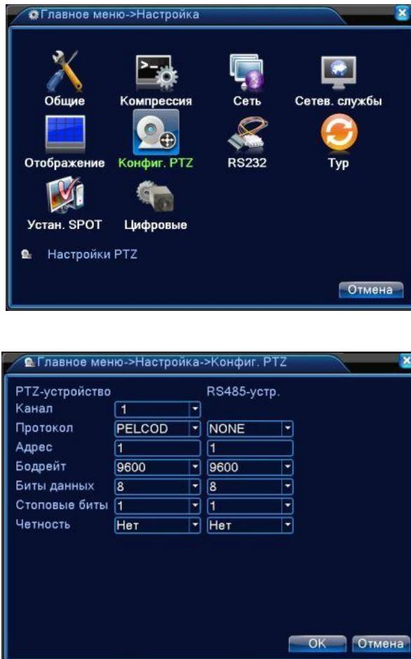
Рисунок 4.37 Конфигурация PTZ и RS485 устройств в аналоговом и гибридном режимах.
