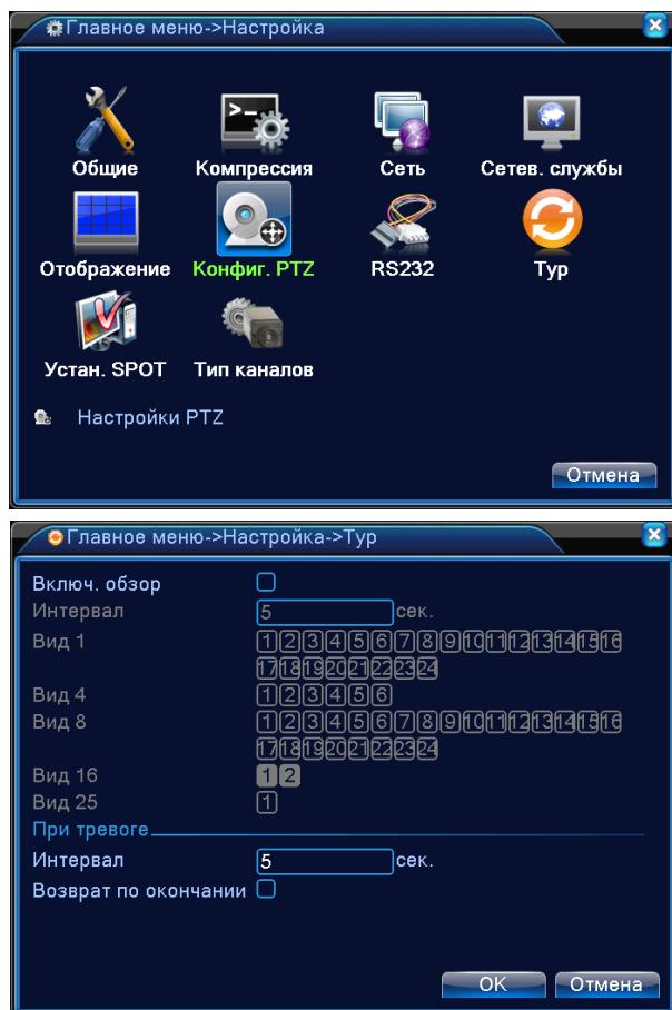
Рисунок 4.40 Настройка патрулирования
