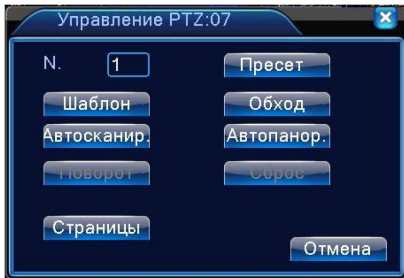
Введите номер сканирования в поле, затем нажмите кнопку **Автосканирование**, камера начнет движение по линии сканирования. Нажмите кнопку "Стоп" для остановки.
