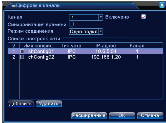
Рисунок 4.45 Поиск устройств при настройке удаленного канала.
