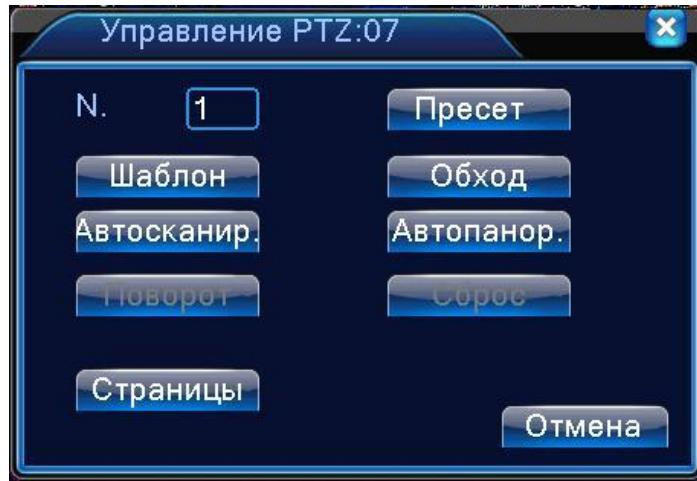
Введите номер сканирования в поле, нажмите кнопку Автосканирование, камера начнет движение по линии сканирования. Нажмите кнопку "Стоп" для остановки.
