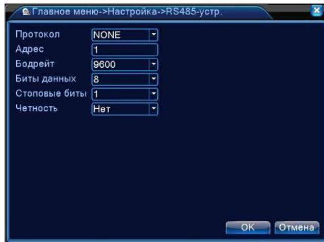
Рисунок 4.38 Конфигурация RS485 устройств в цифровом режиме.
