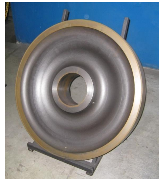
Стальное цельнокатаное колесо с криволинейным диском.
